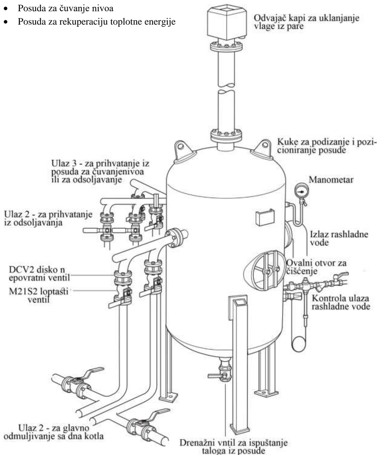
Set za odmuljivanje čine: odvajač kapi, loptasti ventili, diskoviti nepovratni ventili, manometar sa U-cevi, drenažni ventil, sistem za kontrolu ulazne rashladne vode...
